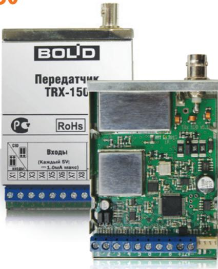
Применяется в составе сетей радиомониторинга в качестве радиопередатчика, обеспечивающего передачу цифровых информационных сообщений от объектового оборудования или информации об изменении состояния собственных входов по радиоканалу на центральный пульт непосредственно или через ретрансляторы. Используется совместно с базовым блоком системы «Орион Радио», который должен включать в себя приёмник RRX-150. Может применяться для трансляции сообщений с пульта C2000M.
