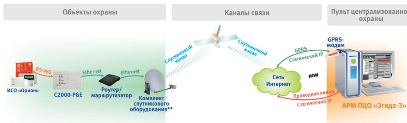
\*\* Комплект используется для подключения к сети Интернет; протестировано с комплектом оборудования Радуга-Интернет
