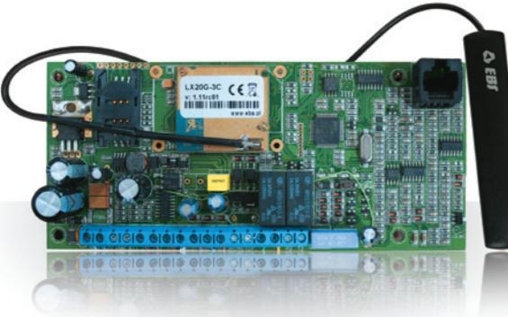
Модуль LX20G предназначен для приёма извещений от различных контрольных панелей и приборов передачи извещений по телефонной линии, их конвертации и последующей передачи этих извещений по GPRS-каналу на OSM.2007 сервер Эгиды-3, а также трансляции событий от собственных ШС и выходов
