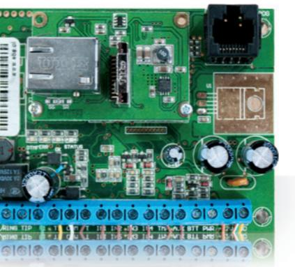
Модуль EX20 предназначен для приёма извещений от различных контрольных панелей и приборов передачи извещений по телефонной линии, их конвертации и последующей передачи этих извещений по локальной сети Ethernet на OSM.2007 сервер Эгид-3, а также трансляции событий от собственных ШС и выходов.
