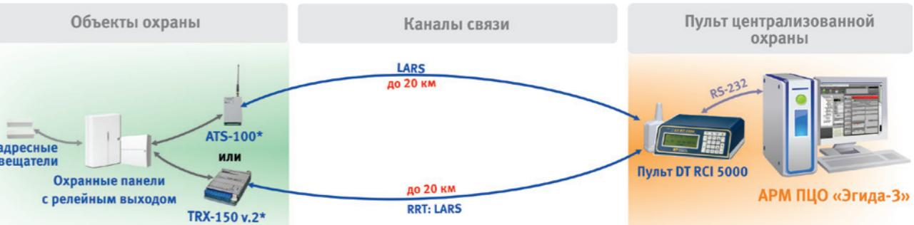
\* Для подключения выходов контрольных панелей используются 8 внутренних входов передатчиков TRX-150 или ATS-100
