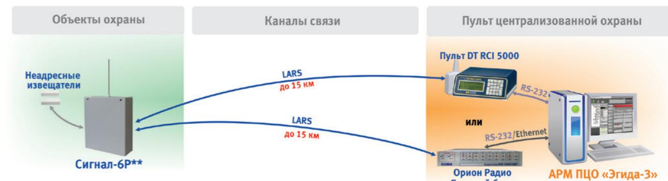
\*\*Расстояние от передатчика до пульта до 15 км в пределах прямой видимости при максимальной мощности передатчика
