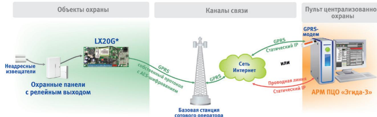
\* Для подключения релейных выходов контрольных панелей используются 3 логических входа прибора LX20G
