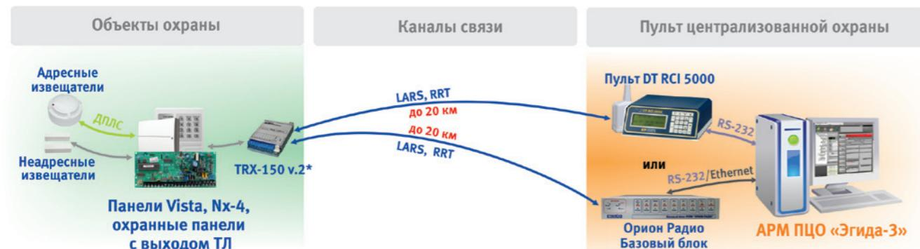
\* Не более 20 км в пределах прямой видимости при максимальной мощности передатчика. Для подключения контрольных панелей используется встроенный коммуникатор телефонной линии TRX-150 v.5
