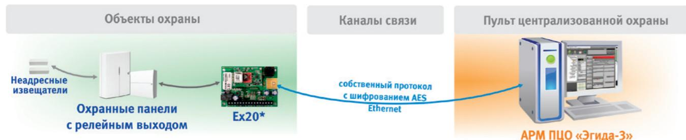
\* Для подключения релейных выходов контрольных панелей используются 4 логических входа прибора EX20
