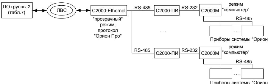
**Рисунок 4** Схема подключения нескольких пультов «C2000»/«C2000M» к виртуальному порту через один C2000-Ethernet
